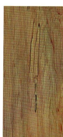
Gavilán: sección longitudinal (130X). Fotografía: Alex Fernández, CEDAA-INII.
