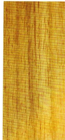
Melina: sección longitudinal (150X). Fotografía: Juan Carlos Fallas, SIEDIN.
