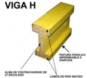
Figura 4-17. Ejemplo de viga "cajón" y viga "I" encoladas (adaptada de la referencia 1)
