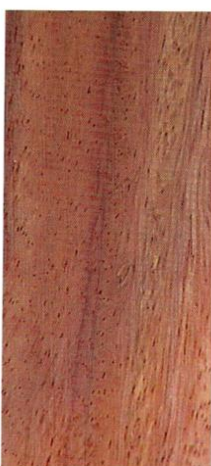
Guanacaste: sección longitudinal (130X). Fotografía: Alex Fernández, CEDAA-INII.
