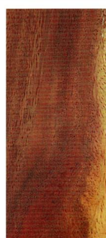
Cenízaro: sección longitudinal (140X). Fotografía: Alex Fernández, CEDAA-INII.
