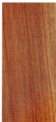
Caobilla: sección longitudinal (130X). Fotografía: Alex Fernández, CEDAA-INII.
