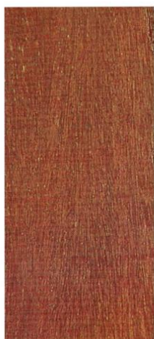
Almendro: sección longitudinal (125X). Fotografía: Alex Fernández, CEDAA-INII.
